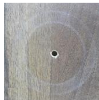
Испытуемые образцы ламината после прохождения Табер теста
