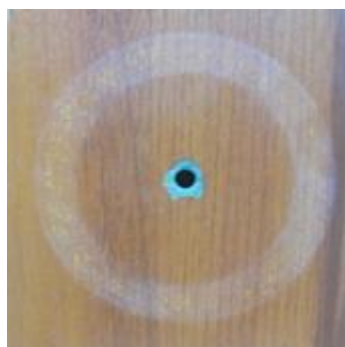
Испытуемые образцы ламината после прохождения Табер теста
