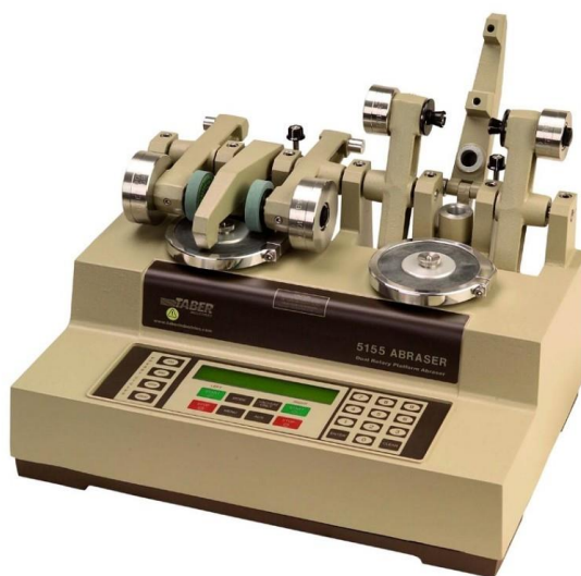
Аппарат для проведения Табер теста
