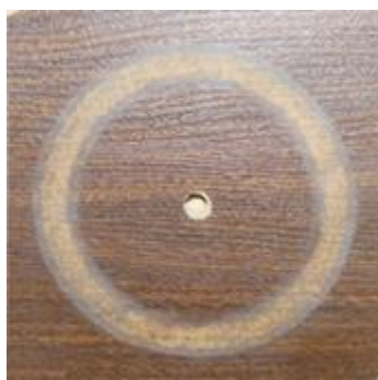
Испытуемые образцы ламината после прохождения Табер теста
